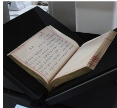
この要求にマッチしたのがユニバーサル・ビジネス・テクノロジーの提供するブックコピーステーション(以下BCS)です。BCSはImage Access社のBookeye 4をブックスキャナーとして採用しており、上向きスキャンで本に優しい複写を実現するとともに、編集PCを必要としないダイレクト印刷やパネル操作でのデータ転送など高い操作性を備えています。
